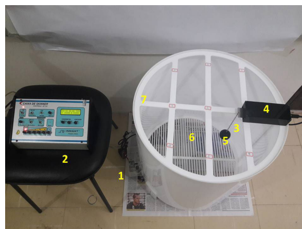
Figura 1: Instrumentos e materiais em configuração da situação de treino e teste. (1) bebedouro na parte interna da caixa; (2) caixa de controle do bebedouro; (3) corrente regulável; (4) barra de acionamento do bebedouro; (5) esfera preta (bola de ping-pong ).
